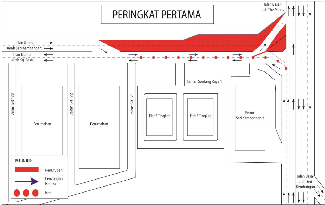
PETA 1(A): LANJUTAN PENUTUPAN PENUH DAN PENGAKTIFAN LALUAN KONTRA SECARA BERPERINGKAT DI SEPANJANG JALAN UTAMA (ARAH SERI KEMBANGAN)
