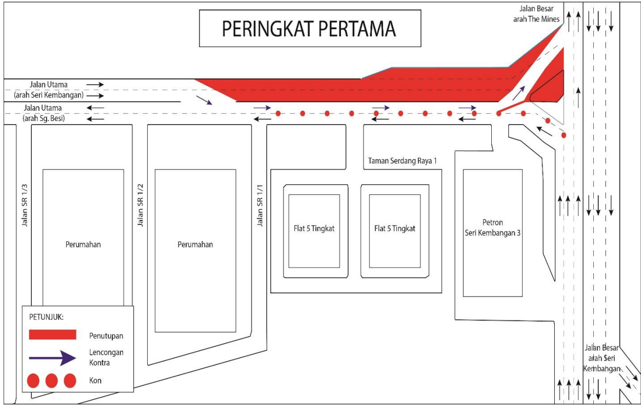
PETA 2(A): PENUTUPAN PENUH DAN PENGAKTIFAN LALUAN KONTRA SECARA BERPERINGKAT DI SEPANJANG JALAN UTAMA (ARAH SERIKEMBANGAN)
