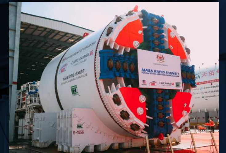
MESIN: Roda pemotong Mesin Pengorek Terowong Pembolehubah Ketumpatan - bahagian depan mesin sepanjang 135m yang akan menembusi tanah dan batuan untuk pembinaan terowong bawah tanah bagi Laluan SSP.
