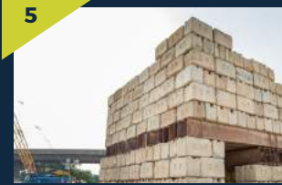
Blok Kentledge untuk Ujian Beban Kekal (MLT) di tapak Stesen MRT Kepong Sentral.
