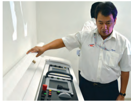
KEMAS • Ketua Pegawai Eksekutif MRT Corp Dato' Azhar Abdul Hamid melihat pengolokan konsol pemandu tren. Tren MRT tiada pemandu dan konsol ini hanya akan digunakan apabila tren ini perlu dipandu secara manual didalam keadaan yang tertentu.
