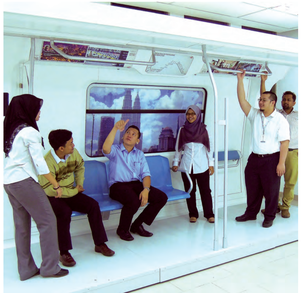
TAPAK UJIAN • Kakitangan bahagian tren elektrik MRT Corp menguji ergonomi tren dengan model ini.
