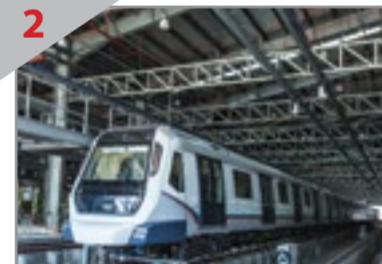
2 BERGAYA Sebuah tren MRT di dalam bangunan penyelenggaraan stok kereta api. Tren tersebut sedang menjalani ujian dinamik di depo.
