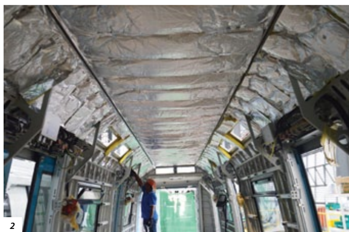
■ 蜕变·列车车厢抵达叻思组装厂时的内观（1），装上隔热层（2），以及经过内部加工（3）。
