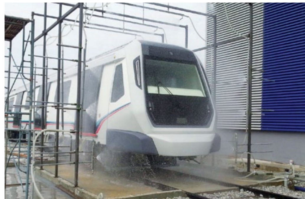
■ 良好水测·所有组装好的列车将经过防水测试，确保没有渗漏。
