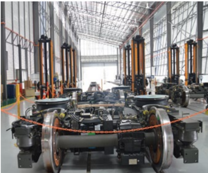
■ 底盘·准备在列车车体底部装置的转向架。
