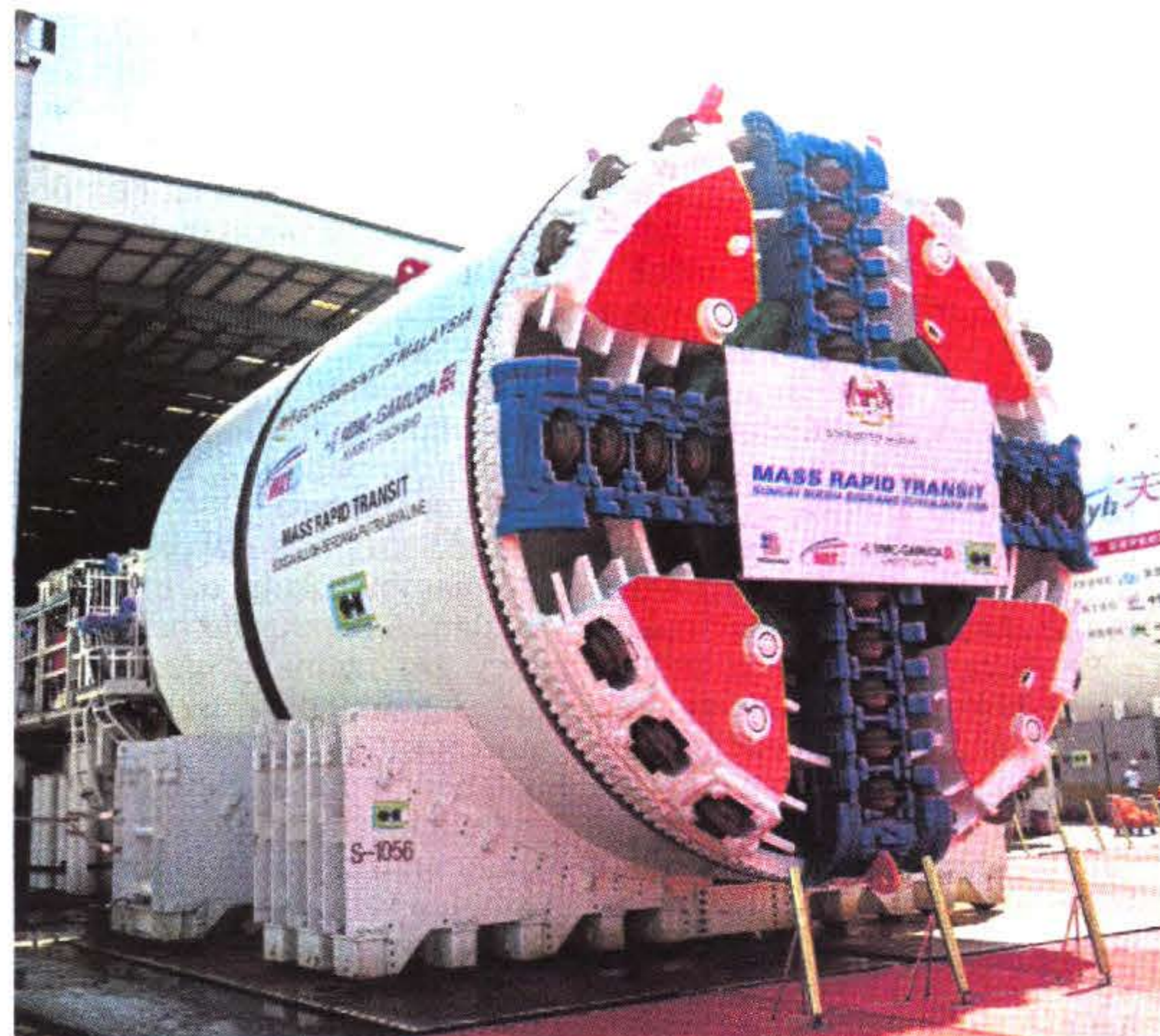
Dua mesin pengorek terowong jenis pembolehubah ketumpatan menjalani ujian penerimaan kilang di Guangzhou, China.
