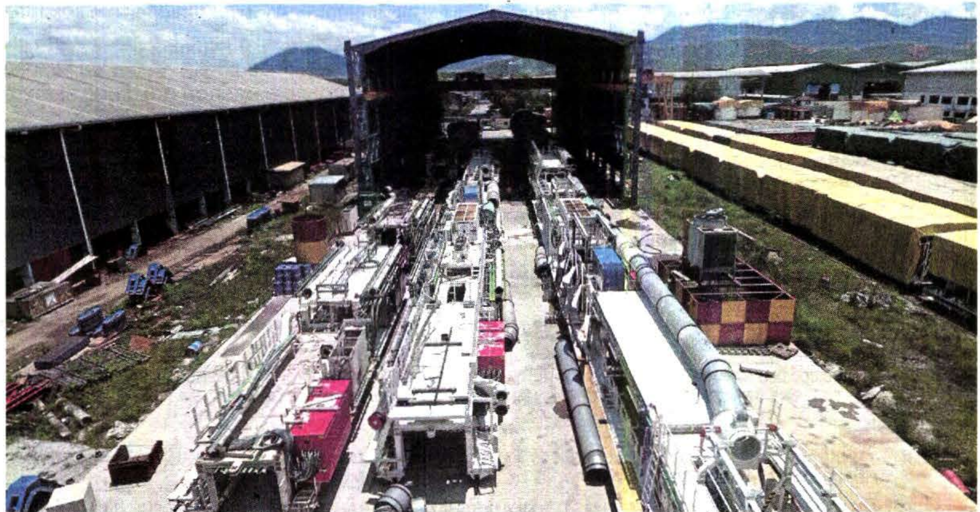
Tenaga pakar tempatan yang berkemahiran ditempatkan di Kilang Pembaikpulih TBM untuk menjalankan kerja penyelenggaraan dan pembaikan mesin TBM di Pusing, Perak.
