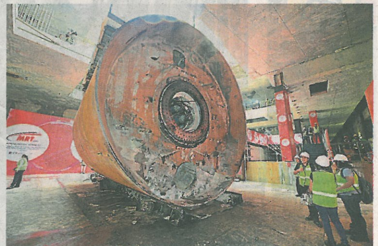
■选用可变密度式隧道掘进机, 可减少发生地陷事故的几率。
